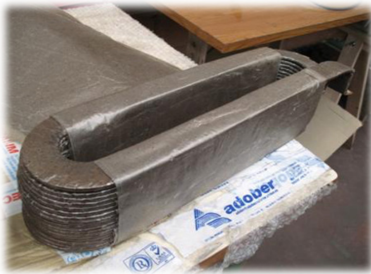
CONSTRUCCIÓN DE BOBINAS DE PLETINA PROCESO DE AISLAMIENTO
