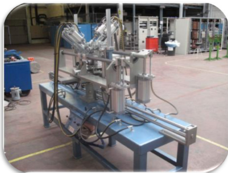
ESTRANGULADORA PARA BOBINAS DE MEDIA TENSIÓN
