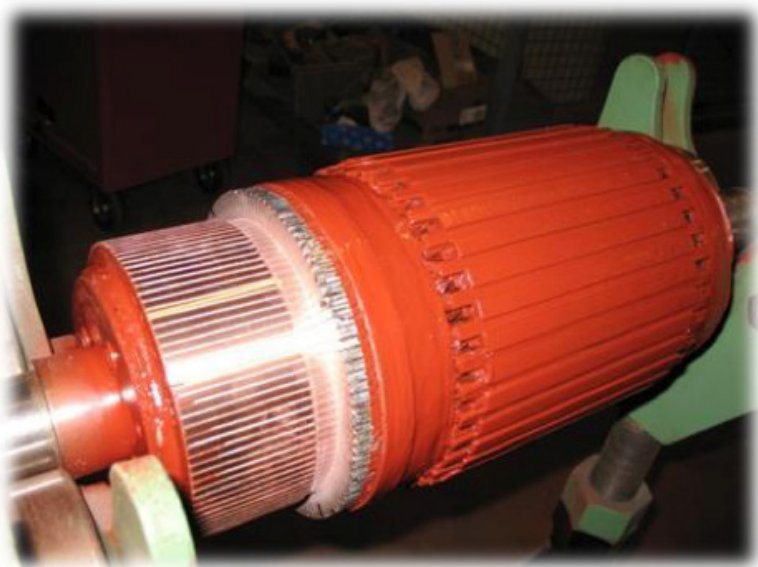
INDUCIDO, PROCESO DE RANURADO, RECTIFICADO Y BISELADO DEL COLECTOR
