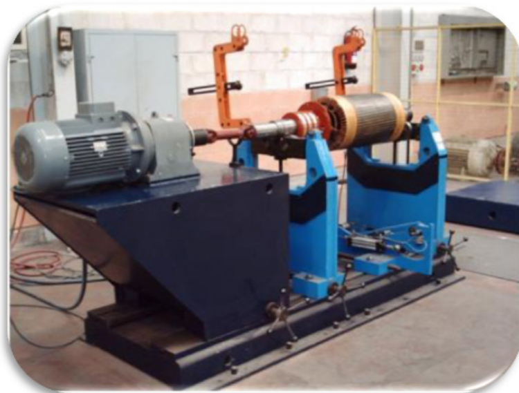
EQUILIBRADORA HASTA 6000 KG
